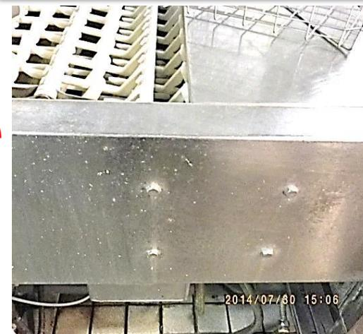
水が飛散して付着したスケール。軟溶化していますが、水流がない為に清掃という物理的なエネルギーが必要です。
