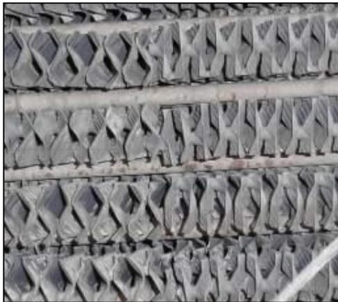
同社内別途密閉型冷却塔で薬注装置不具合により薬注装置が3日間停止した後の内部銅管状況
